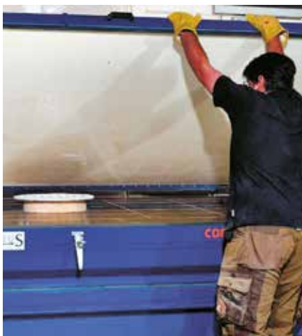
Ein Mitarbeiter von Raphael Haas bedient die Vakuumpresse, mit der das Staron-Material in Form gebracht wird.
